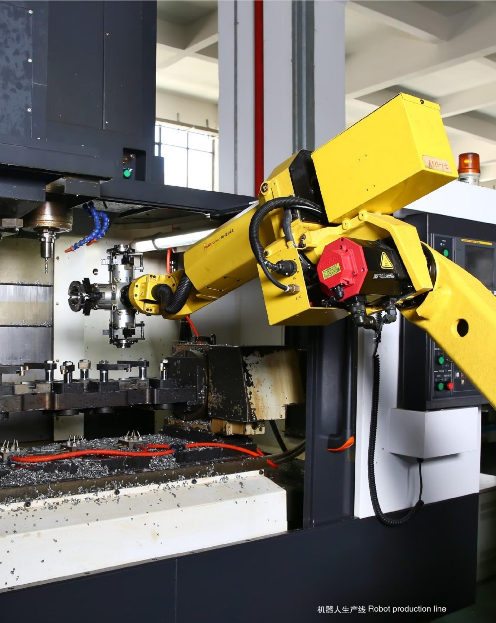
机器人生产线 Robot production line
